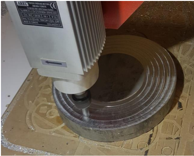
Hub Motor Parçalarının CNC Tezgâhta İşlenmesi Modellenen Hub Motor
