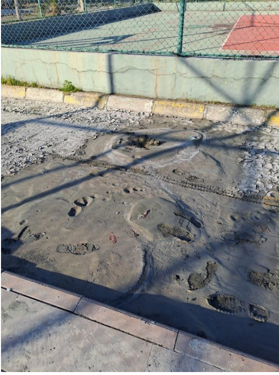
Şekil 21. İskenderun'da sahil kenarındaki parkta boş arazide sıvılaşma sonucu gözlenen kum konileri ve denize doğru gelişen yanal yayılma yarıkları
