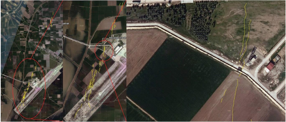
Şekil 5. Hatay havalimanı bölgesinde gözlenen deprem yüzey kırığı (Temiz, 2023)
