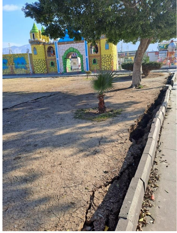
Şekil 21. İskenderun'da sahil kenarındaki parkta boş arazide sıvılaşma sonucu gözlenen kum konileri ve denize doğru gelişen yanal yayılma yarıkları
