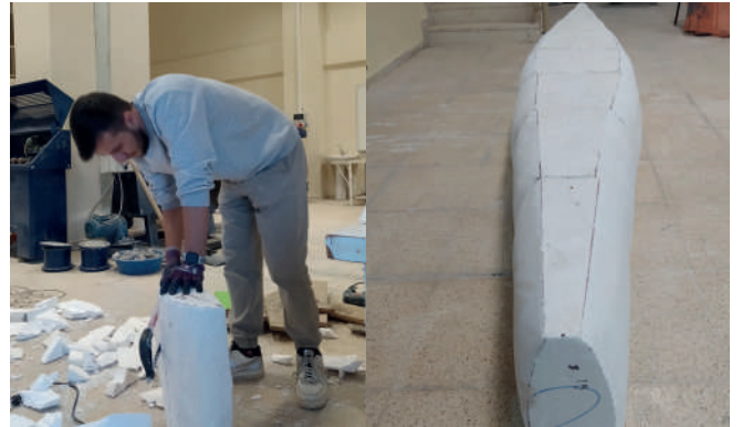
Şekil 3. Tıraşlama İşlemi ve Kalıp
