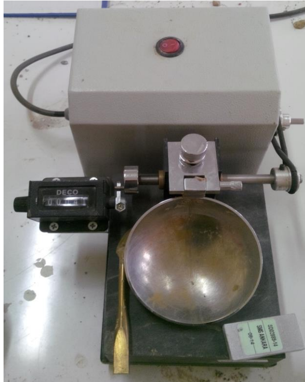
Şekil 4. Likit Limit (Otomatik Casagrande) deney aleti
