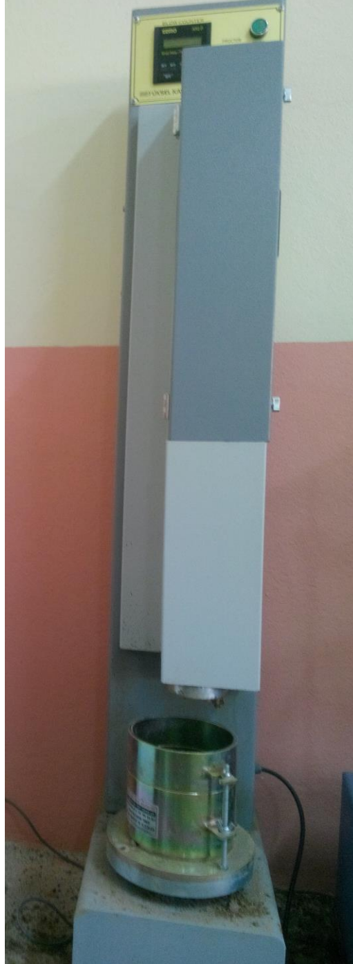
Őekil 10. Otomatik proktor (kompaksiyon) deney aleti
