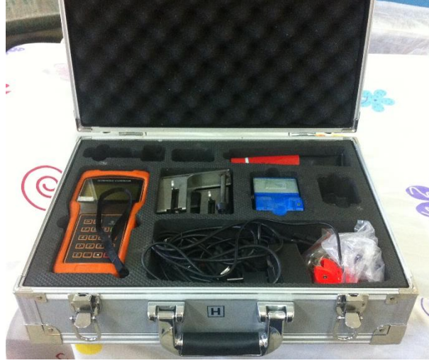
Şekil 3. Ultrasonik debi ölçer (Modeli: TUF-2000H)
