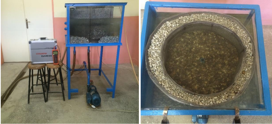
Şekil 4. Durgun su ortamında su alma deney düzeneği
