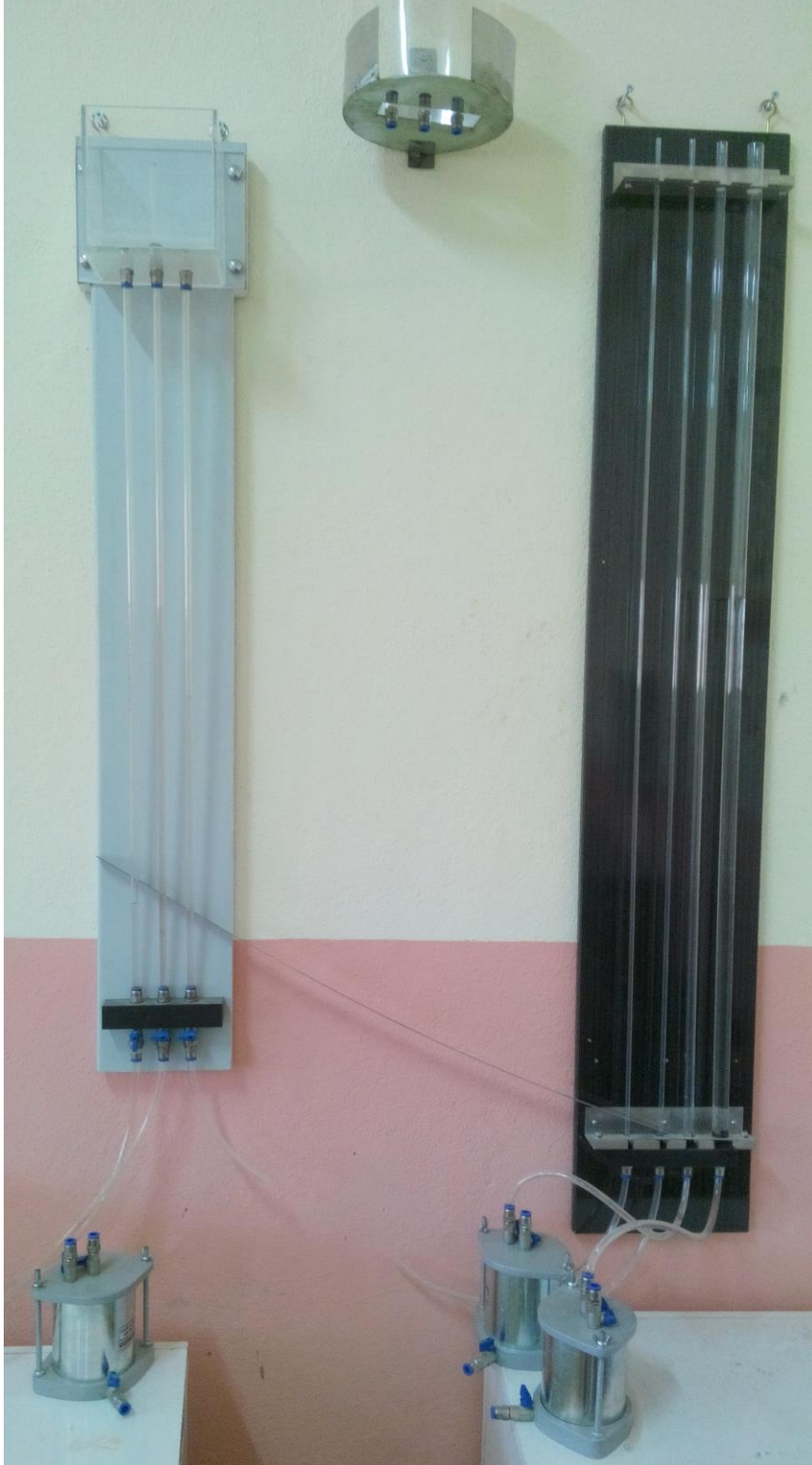
Şekil 9. Sabit ve Düşen Seviyeli Permeabilite deney aleti
