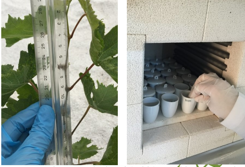
Şekil. Örneklerin sürgün uzunluğunun ölçülmesi (solda), örneklerin mineral madde analizlerine hazırlık olarak kül fırınında yakılması (sağda)
