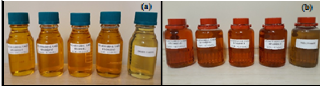
Şekil 2. (a) Yakıt özelliklerinin tespiti ve (b) motor performans ve egzoz emisyon ölçümleri için hazırlanan yakıt numuneleri
