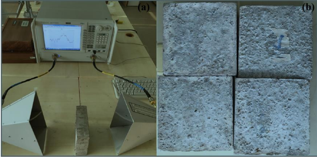
Şekil 1: Değişik fiber içeren betonların üretilmiş hali ve dielektrik katsayı ölçümleri
